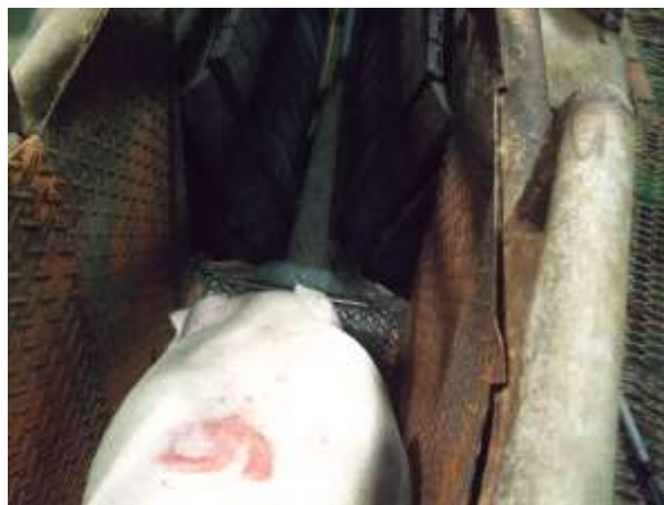
圖五十七、夾豬機入口地面不宜切除
