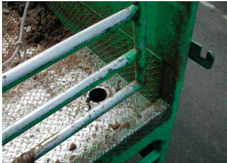
圖五十八、運牛車車斗之污水收集口
